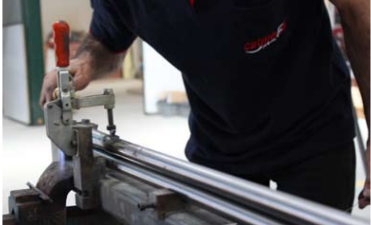
Obróbka bloku luf
